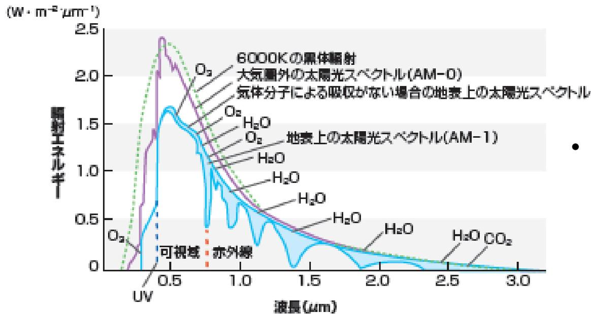
地球上の大気を通過すると、水(H<sub>2</sub>O)、酸素(O<sub>2</sub>)、二酸化炭素(CO<sub>2</sub>)による吸収がディップ(落ち込み)となって見られる
