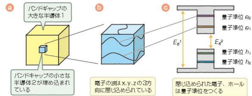
図3 量子ドット超格子の電子状態
