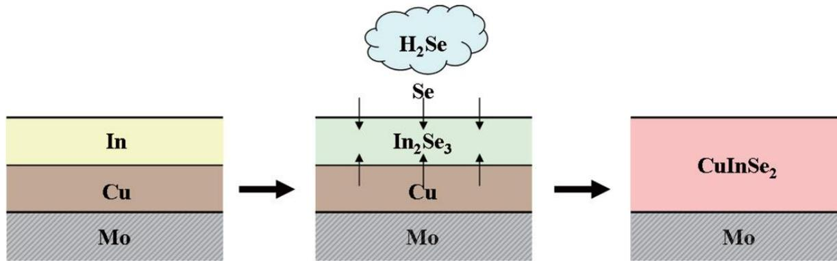
Mo 裏面電極の上にCu, In の順に金属膜を形成. その積層膜をH<sub>2</sub>Se ガス中で熱処理→まず表面のIn がH<sub>2</sub>Se と反応してIn<sub>2</sub>Se<sub>3</sub> が生成.
