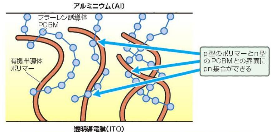
バルクヘテロ型有機太陽電池では、透明導電膜ITOをつけたガラス基板の上に、電子受容体(p型)の有機半導体ポリマーと電子供与体(n型)のフラレン誘導体PCBMとの混合物を塗布し、裏面電極としてアルミニウムをつける。光照射によって、有機半導体で光キャリアのペアが生じ、ポリマーとPCBMが絡み合っただけの界面の内蔵電位差で分離され、ITOがマイナス、アルミニウムがプラスになる
