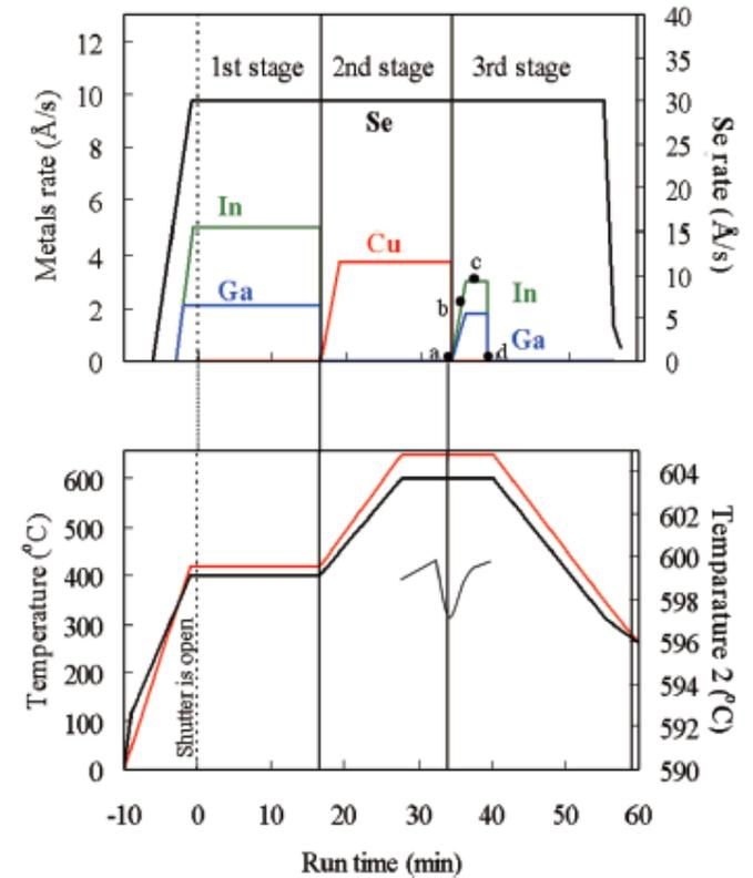
ダブルグレーデッドバンドギャップにより、開放端電圧 (Voc) と短絡電流密度 (Jsc) の両方を大きくできる。
