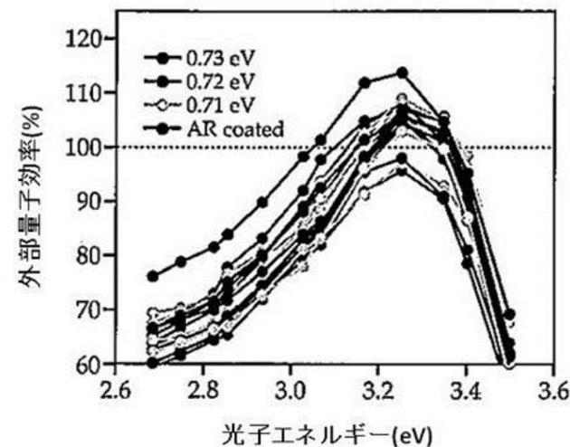
ナノ結晶量子ドットセルの外部量子効率は100%を超えますが、実際の変換効率は、理論変換効率にも達していません。
