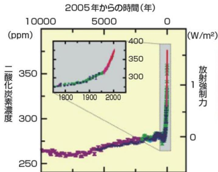
過去1万年(大きい図)および1750年以降(挿入された図)の二酸化炭素の大気中濃度。測定値は氷床コア(異なる色の印は異なる研究を示す)と、大気中のサンプル(線)によるもの。大きい図の右軸は、対応する放射強制力
