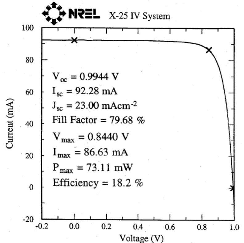
サブmmの粒径を有する多結晶Ge基板上的多結晶GaAs太陽電池のI-V特性
