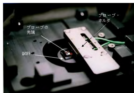
図 20 試料付近の拡大図
