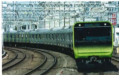
4章では、電気と磁気を応用したモーターを学んだ。電車が動くとき、車輪を回しているのはモーターである。かつて、電車の速度を制限するためには限られた複数の抵抗を切り替え、モーターの回転速度を変える必要があった。そのため、低速で走る際に抵抗でのエネルギー損失が大きくなってしまうという課題があった。しかし、最近の電車は、半導体を用いてモーターの回転数を制御
