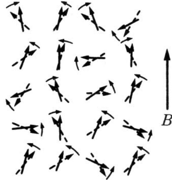
(b) 磁界のある場合 磁気モーメントが少し ずつ磁界方向に向き、 全体として磁化をもつ
