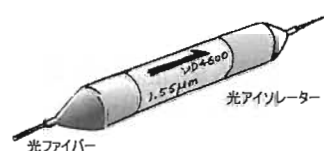
Fig. 5 光ファイバー通信において戻り光が半導体レーザーに入ることを防ぐための光アイソレーターには、通信用赤外線に対して透明な磁性体YIGがファラデー回転子として使われている。
