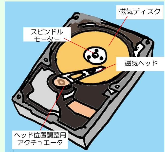
図1.3 パソコンのハードディスクドライブ(HDD)には、記録媒体としてハード磁性体が、記録ヘッドにはソフト磁性体が使われている
