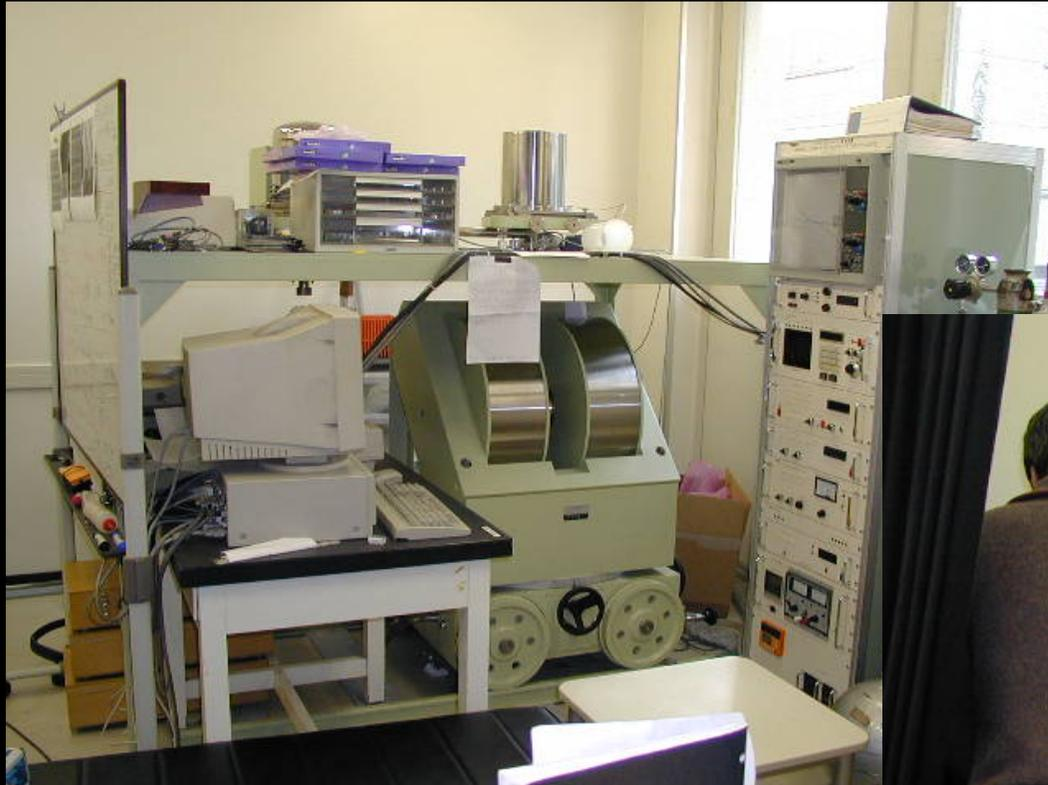
←VSM装置で物質の磁化を測定します。
