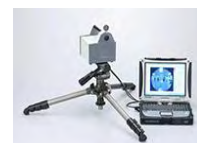
左：小型・軽量ガンマ線撮像用コンプトンカメラ （「放射線計測」H24-25）
